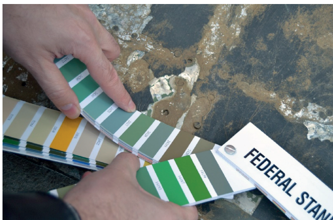
3. ábra. A spektrofotométeres vizsgálattal párhuzamosan színkártyás színárnyalat-azonosítás is készült (hivatalos Federal Standard FS-595C színkártya-szettel), különböző roncsdarabokon (kizárólag hozzátvetőleges színazonosság megállapítása végett)
