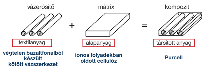
1. ábra. A Purcell-kompozit felépítése
