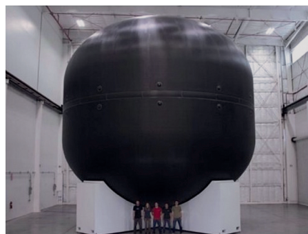
10. ábra. Gigantikus szénszálas és grafittal kombinált gömb, űrhajó tüzelőanyagának tárolására
