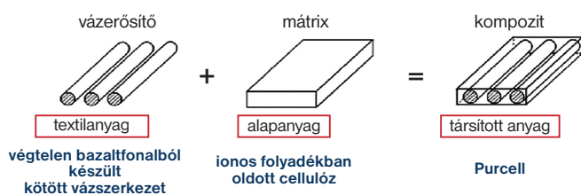
1. ábra. A Purcell-kompozit felépítése
