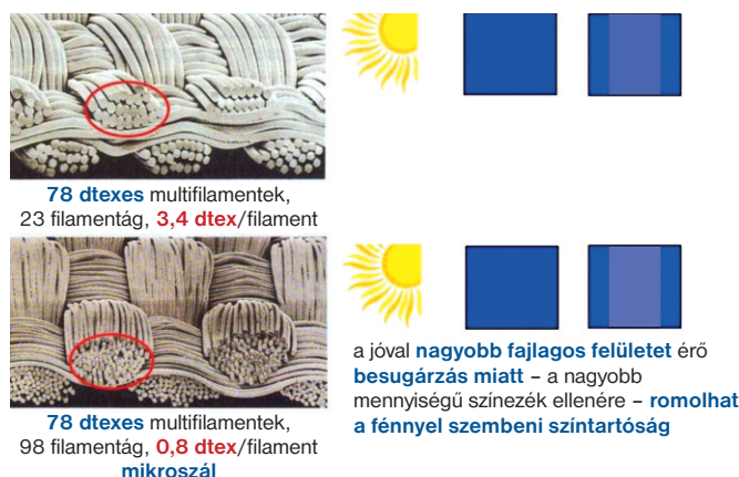
3. ábra. A normál finomságú és a mikroszálalapú multifilamentekből készült, azonos szerkezetű szövetek összehasonlítása
