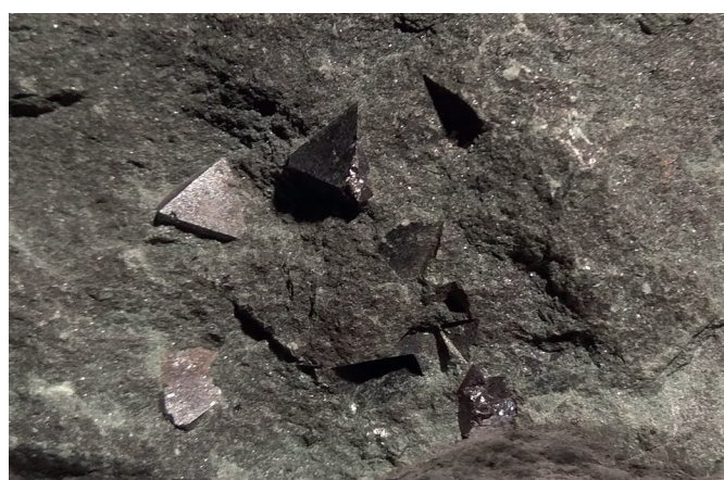
2. ábra. Oktaéderez magnetitkristályok (élhossz: 7 mm) kloritpalában (Pfisch) az SZTE Ásványtani, Geokémiai és Kőzettani Tanszékének Koch Sándor Ásványgyűjteményében
