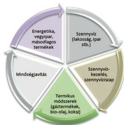
1. ábra. A szennyvíziszap termikus hasznosítása a körforgásos gazdaság figyelembevételével
