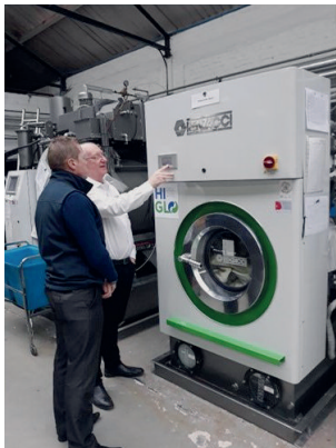
8. ábra. A perklór-etilén kiváltása a vegytisztításnál egyedi oldószerkeverékkel és speciális berendezéssel
