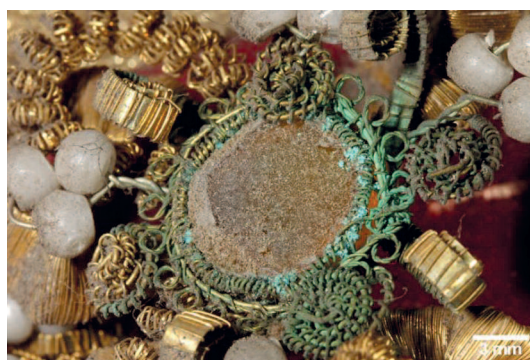
Üvegtől (és környezettől) eredő korrózió egy 18. századi ékszeren
