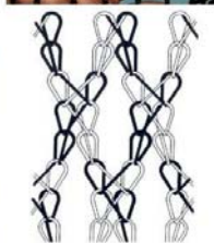
csomómentes, raschel- gépi, láncrendszerű kötött háló
