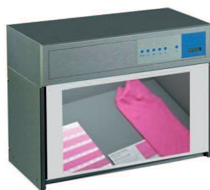
6. ábra. Színek vizuális összehasonlítására alkalmas eszköz
