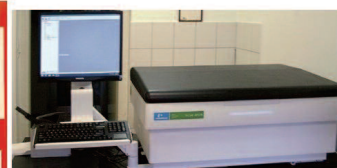
folyadékcintillációs spektrométer a szén radioaktivitásának mérésére
