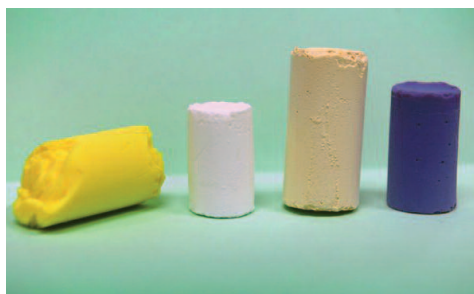
Kapton, kevlár és funkcionizált szilika-aerogél-tömbök
