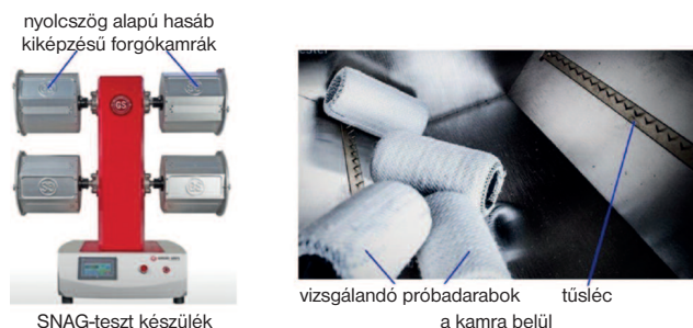
4. ábra. A száلكihúzóási hajlam forgókamrás vizsgálata
