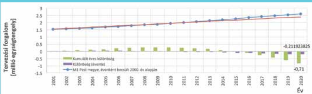
3. ábra: Az egyszerűsítés által okozott hiba az M1 autópálya 2000. évi forgalmi adatai alapján becsült tervezési forgalom esetén
