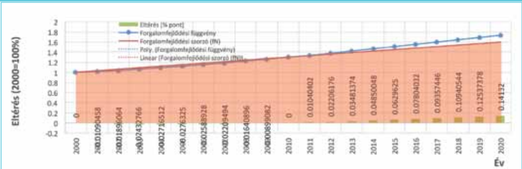
3. ábra: Az egyszerűsítés által okozott hiba az M1 autópálya 2000. évi forgalmi adatai alapján becsült tervezési forgalom esetén
