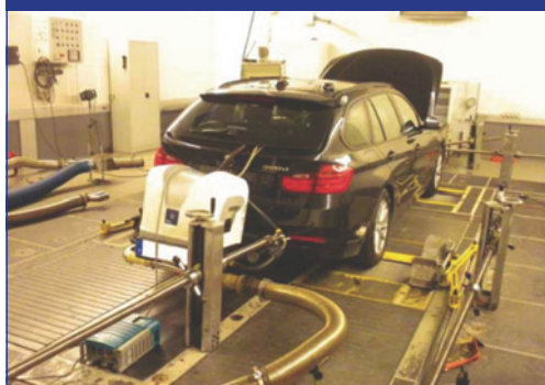
4. ábra: A KBA görgős próbapadja a kísérleti gépjárművel, a kipufogó cső közelébe szerelt PEMS rendszerrel
