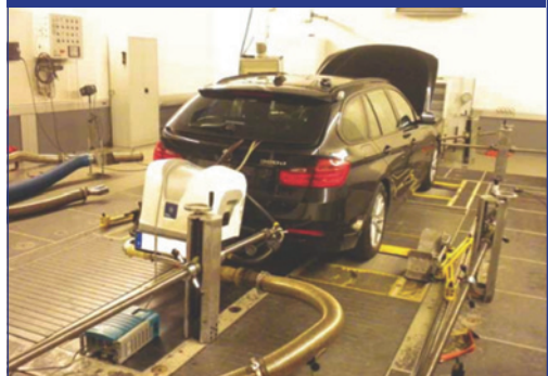
4. ábra: A KBA görgős próbapadja a kísérleti gépjárművel, a kipufogó cső közelébe szerelt PEMS rendszerrel
