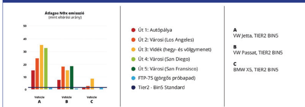
1. ábra: Az USA-ban a PEMS rendszerrel bevizsgált VW Jetta, VW Passat és BMW típusú gépjármű emissziós eredményei az RDE mérések után
