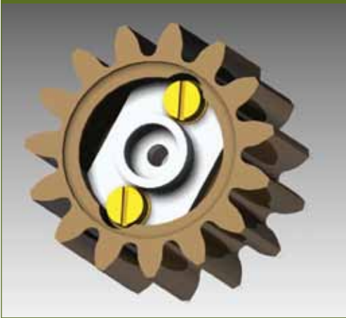
8. ábra: A fogaskerék és a tengely kapcsolata
