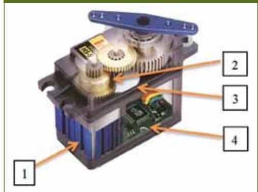
15. ábra: A szervomotor általános felépítése [16]
