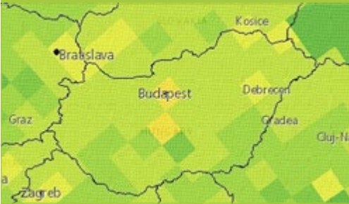
2/a. ábra: Az eredeti 50x50km 2 -es rácshálón ábrázolt PM10 kibocsátás
