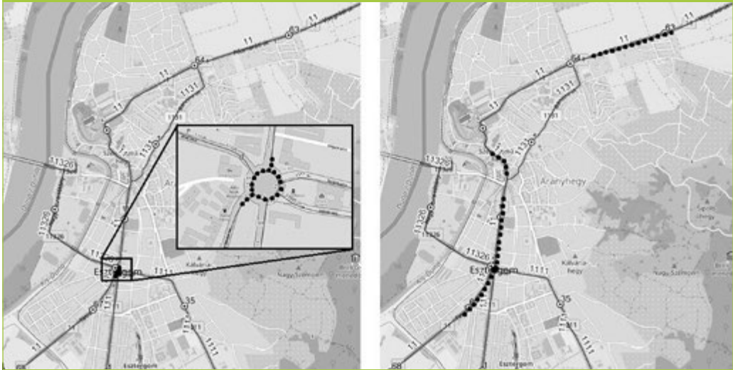
4. ábra: A távolságmátrix módszerrel (bal oldali) és a KDE módszerrel (jobb oldali) eredményül kapott baleset-sűrűsödési helyek
