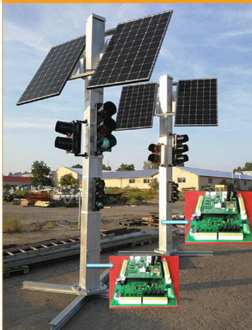
10. ábra: Az elosztott jelzőlámpa-rendszer prototípusa; a vezérlőegységek az oszlopokba kerültek elhelyezésre (a megvalósítást az MS Kft. támogatta)
