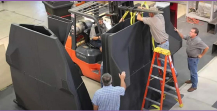
3. ábra: A nagyobb darabokat sokszor kézzel kell összeszerelni, mert a viszonylag nagy íves elemek gépi gyártás során elbillenhetnek [6]
