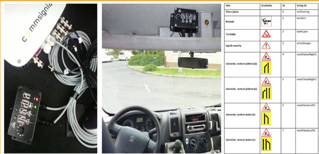
5. ábra: Fedélzeti egység és kapcsolótábla az egyes állásokhoz tartozó kódolással (Forrás: Magyar Közút Nzrt.)
