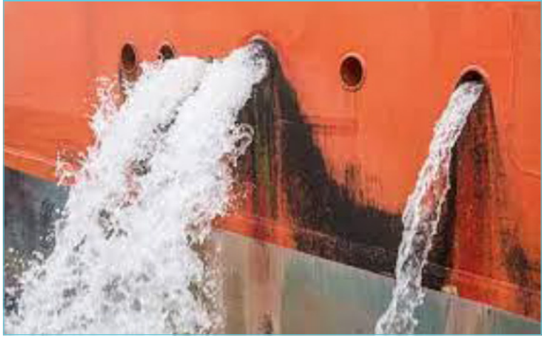
2. ábra: A ballasztvíz intenzív kidobása a hajóból a célkikötőben
