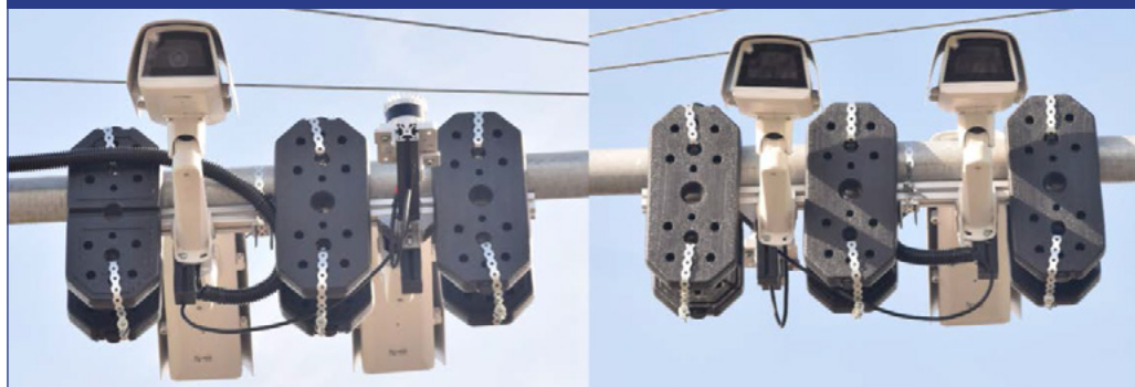
3. ábra: A kísérleti szenzorok és a nehezékek, amelyek a végső szenzorfürt tömegét modellezzik
