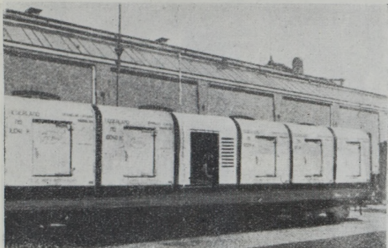
2. ábra. A holland vasutak mélyhűtésű szállító-tartály-csoportja.
