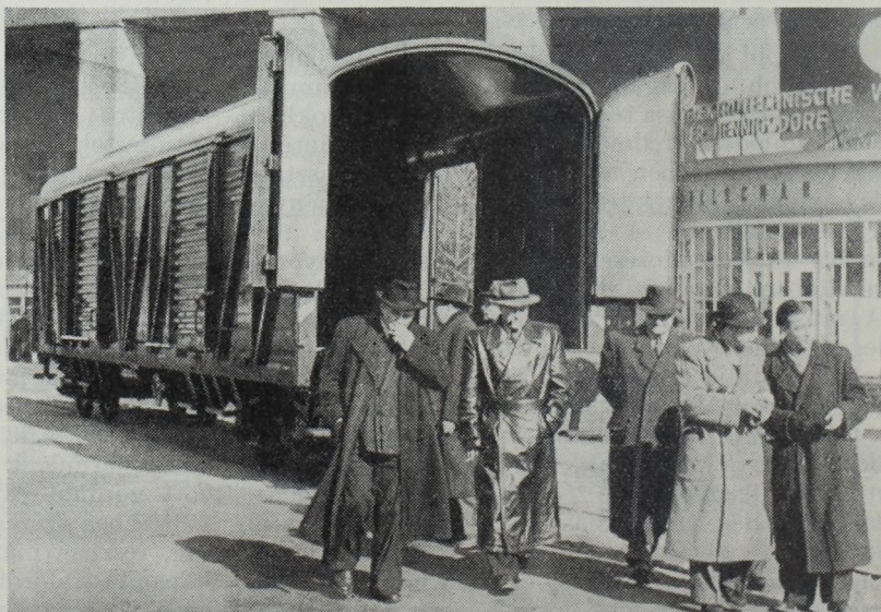
3. ábra. Új, négytengelyes teherkocsi
