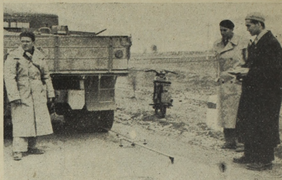
10. ábra. Az útpályaszerkezet lehajlásának mérése billenőkaros készülékkel
