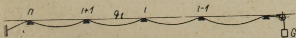
8. ábra. Az i - i + 1 feszítvány körülményei n db. támaszon felfekvő G súllyal feszített tartókötél esetén
