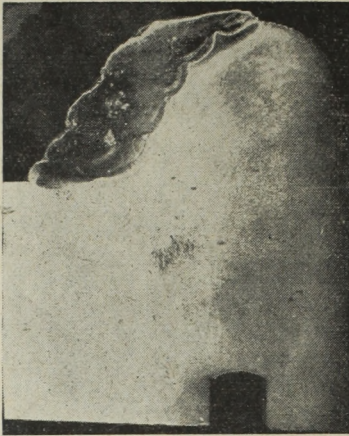
3. ábra. Automatikus hegesztéssel, csupasz elektródával, előmelegítés nélkül végzett mozdonyabroncs nyomkarima-feltöltésénél keletkezett hólyagok
