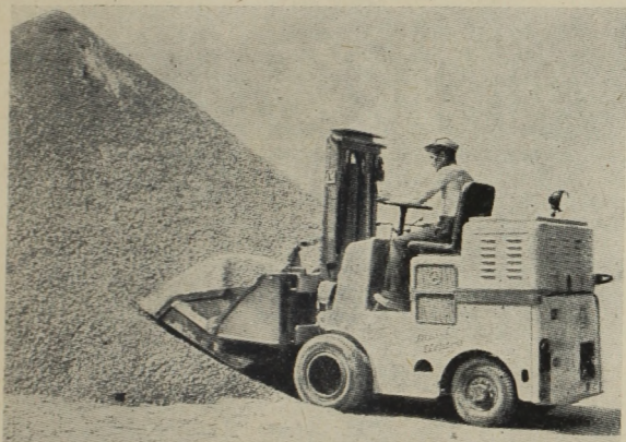
11/a ábra. Diesel-villamos rakodó-targonca: az önműködő mechanikus lapát megtöltése
