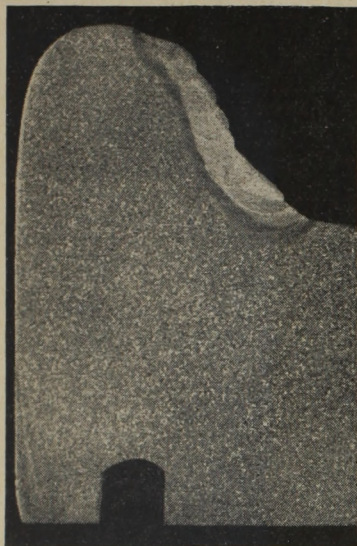
15. ábra. Feltöltő hegesztéssel hegesztett mozdony kerék-abroncs metszete
