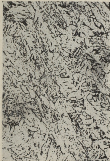
10. ábra. A feltöltő anyag szövetszerkezete kocsibrónesnél
