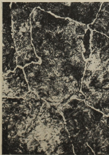
18. ábra. A mozdonyabroncs hegesztés előtti szövetszerkezete
