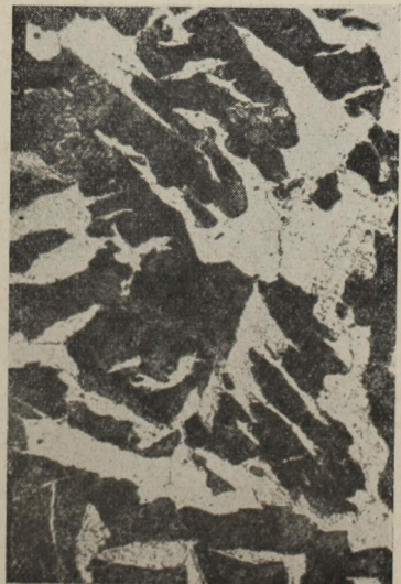
11. ábra. Kocsibrónes alapanyag szövetszerkezete
