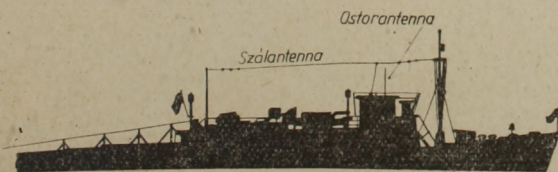
5. ábra. Motoros vontató antennarendszere
