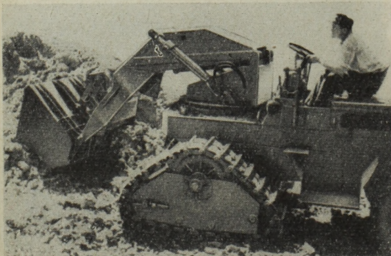
7. ábra. Forgó-rakodógép (segédlánckerékkel és rakodókanállal)
