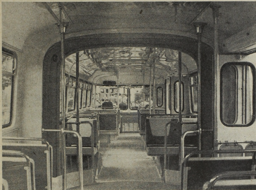
2. ábra. Az Ikarus K-180 ízelt autóbusz belső utastere 160 utas befogadására készült; esüetsforgalomban 190 utast is befogad
