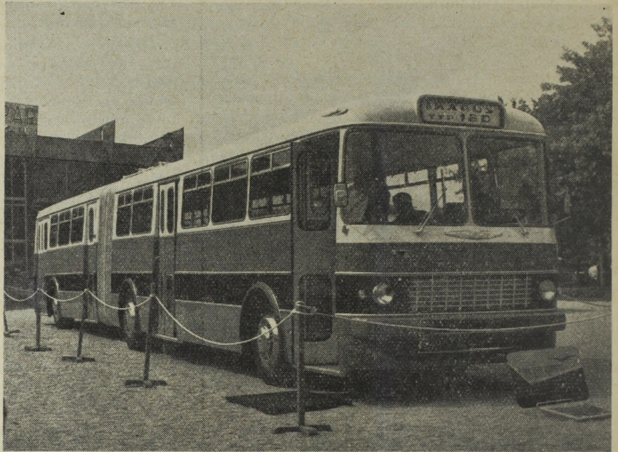
1. ábra. Az Ikarus gyár K 180 típusú városi izelt autóbúsa, a padló alá süllyesztett motorral
