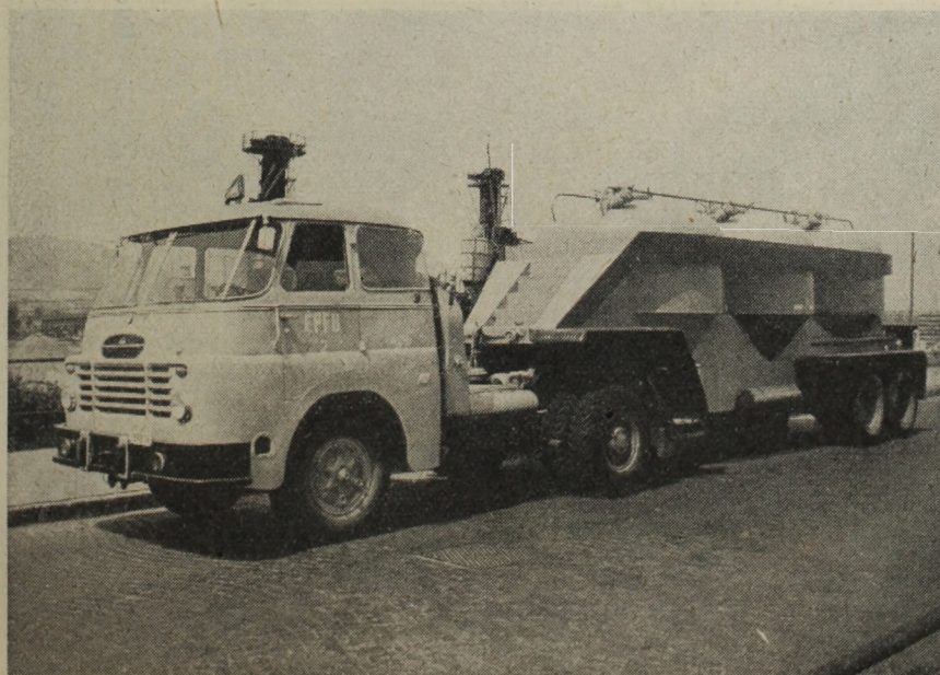
6. ábra. Töltő és ürítő gépi berendezéssel ellátott Csepel 15 tonnás cementszállító gépkocsi
