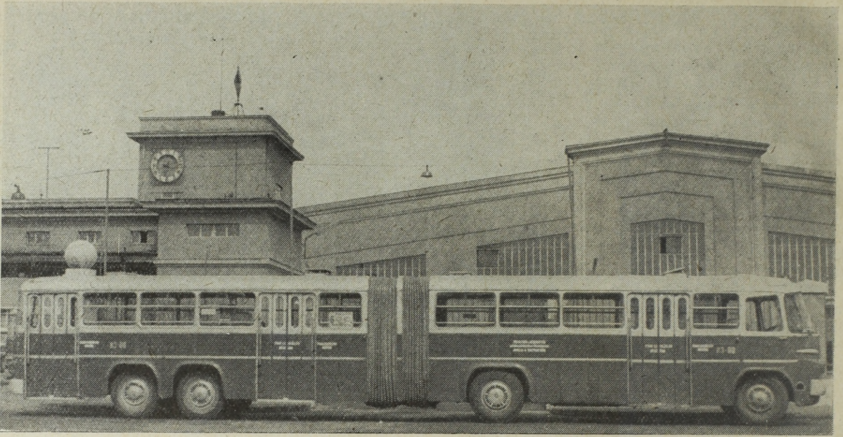
4. ábra. Négytengelyű csuklós autóbusz (FAÜ-IC 622)
