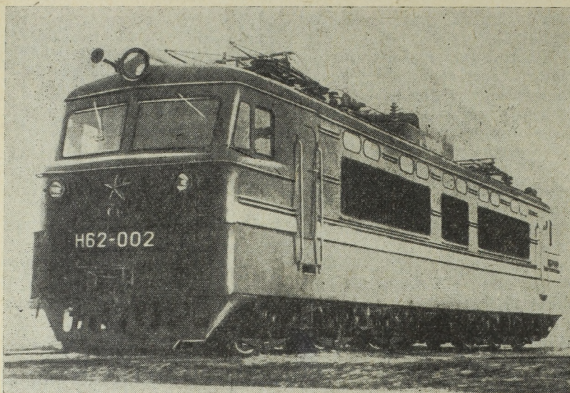
5. ábra. Az N 62 sorozatú villamosmozdony
