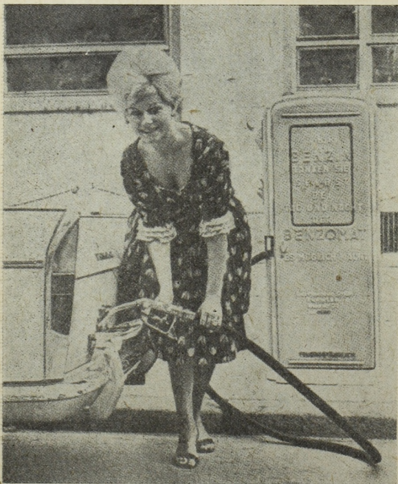
8. ábra. Önkiszolgáltató üzemanyagtöltő állomás. A bedobott pénzdarabok számától függően bármilyen mennyiségű üzemanyag vételezhető. A NSZK gyártmányú berendezés egyelőre csak a skandináv államokban használatos.
