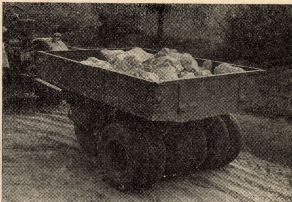
4. ábra. A gumiabroncsos henger a töltés-rétegek és a földútpályák tömörítésének egyik legkorszerűbb eszköze
