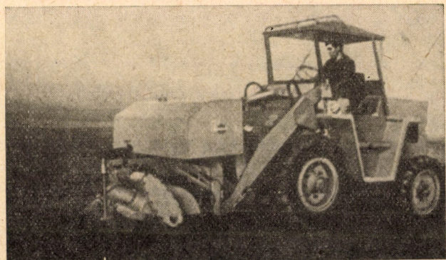
6. ábra. A nyugatnémet Zettelmayer cég Europ. L 500 típusú többcéltű rakodó- és munkagépe
