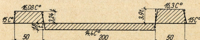
23. ábra. A 22. ábrán bemutatott semleges hőmérséklet megváltozása a hosszellenállás 200 m hosszban történő megszüntetése után
