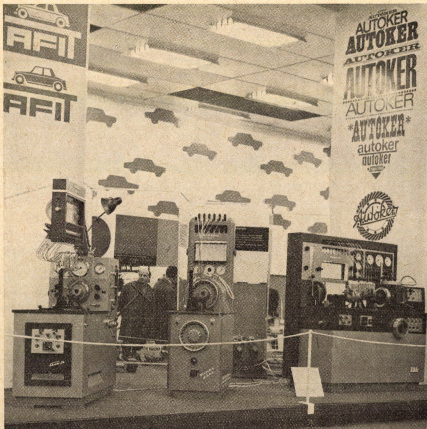
4. ábra. A MIRKÖZ által kiállított „Star” típusú díjnyertes Diesel-adagoló próbapad sorozat
