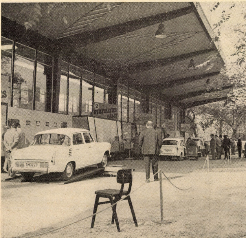
8. ábra. Az ATUKI által bemutatott korszerű műszeres gépkocsi-vizsgáló sor a kiállítás területén, szalagszerű üzemben. Előtérben a görgős fékhatás-ellenőrző berendezés
