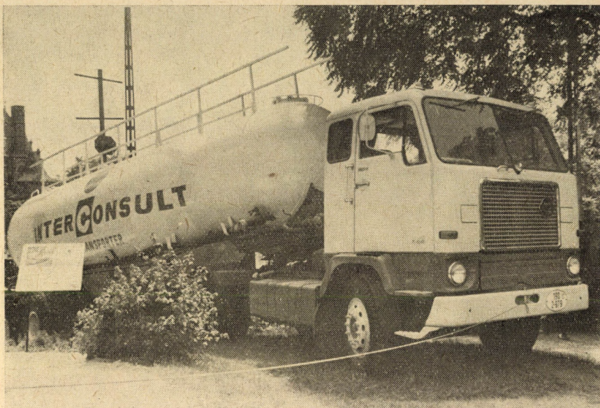
6. ábra. A svéd Volvo gyár ömlesztett cement szállítására készített óriási méretű nyerges tartály-szerelvényre. A vontató F 88 típusú, a tartály térfogata 32 m 3
