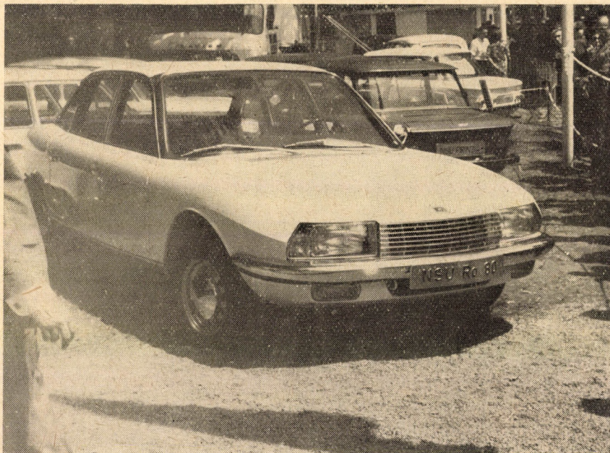
7. ábra. Az NSU Ro 80 típusú, forgódugattyús motorral szerelt, elsőkerék-hajtású autójújdonság, a vásár egyik szenzációja
