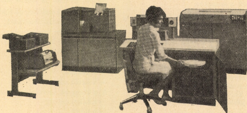
9. ábra. IBM 1130 típusú számítógép. Részei balról jobbra: szalaglyukasztó, leolvasó és grafikonrajzoló, kártyalyukasztó és leolvasó, számítóblokk, nyomtatógép
