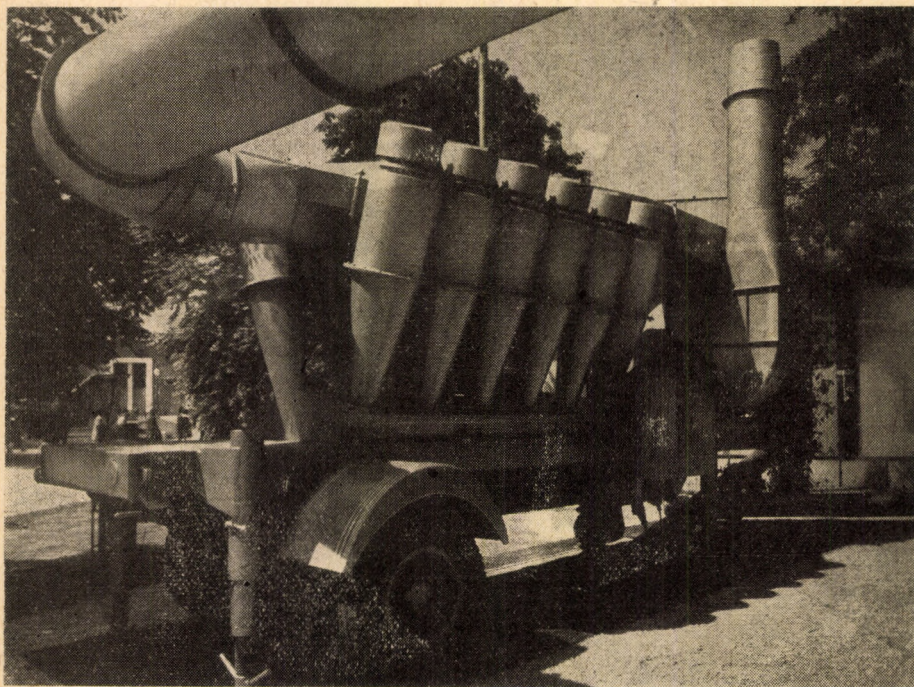
5. ábra. C 25 típusú aszfaltkeverő gép (Tervező: Dr. Burkus Ferenc és Tari István. UVATERV)
