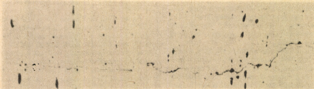
3a. ábra. Vese alakú repedést tartalmazó, de még el nem törött sín metszetéről készült mikrokép. A mikroszkópi eszisolathoz a metszetet a sín hosszirányában, a 2. ábrán vonallal megjelölt helynek megfelelően vettük. Az ábra a repedés kb. 50x-es nagyítású képét mutatja maratlan eszisolaton ott, ahol a göcrepedés a fáradásos repedésbe átmegy. Határozottan felismerhető a kétféle repedés eltérő jellege
