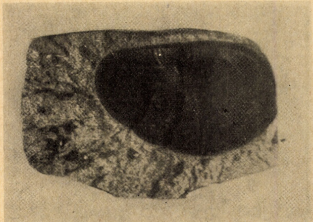
1. ábra. Vese típusú sítörés, amelynél a repedés már a sínfej felületéig kiért, így a repedésbe hatoló nedvesség a fáradásos repedés felületét némileg korrodeálta
