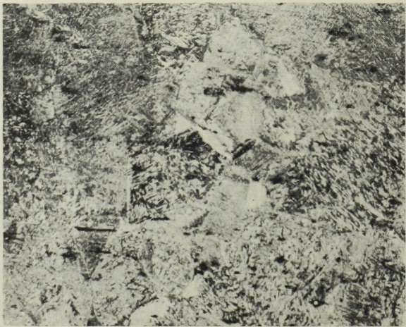
6. ábra. A felületileg edzett sínefj mikroszerkezete 2 mm távolságra a futófelület alatt
