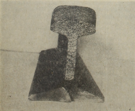
13. ábra. A felületileg edzett sín törete
