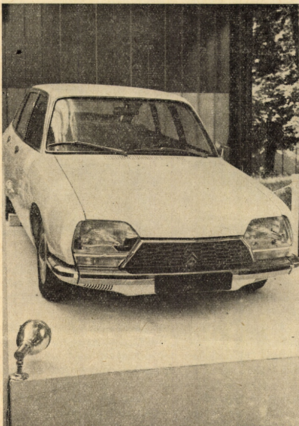
5. ábra. A Citroën autógyár legújabb terméke, a GS típusú, elsőkerék-meghajtású, hidropneumatikus rugózású személyautó, az „év autója” cím idei nyertese
