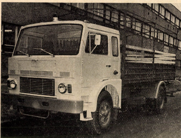
38. ábra. 8,9 t áru szállítására alkalmas a D730 járműcsalád D730.00 jelű alaptípusa
