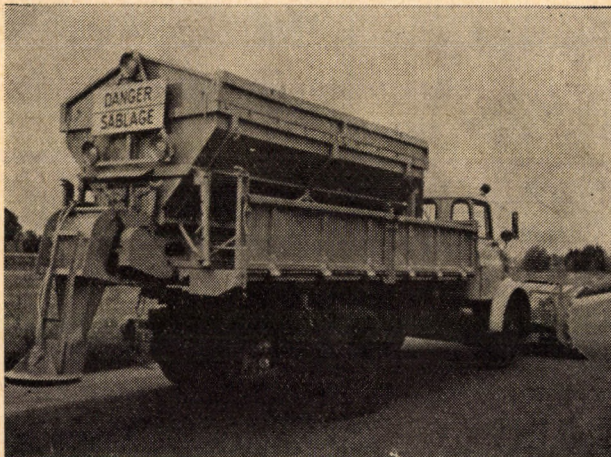
6. ábra. 6 m 3 űrtartalmú szórógép, Berliet GLR 160 tehergépkocsira szerelve
