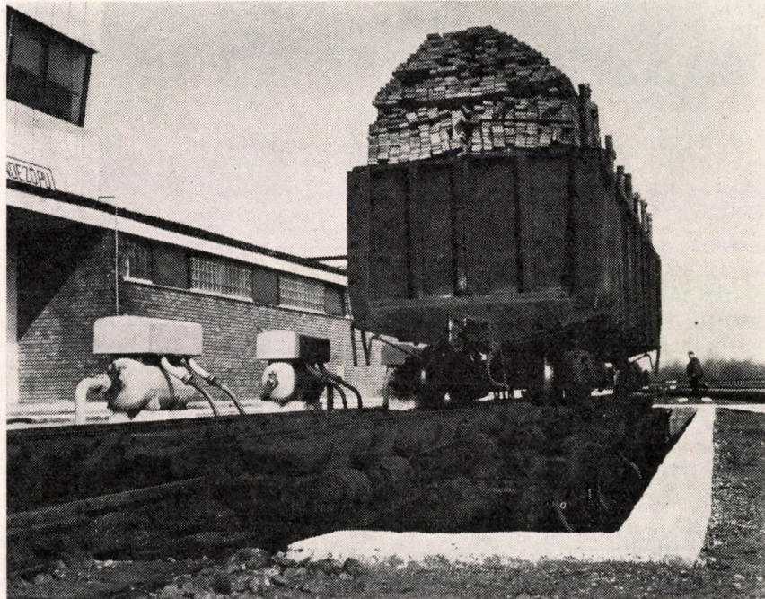
8. ábra. Szovjet gyártmányú vágányfék-berendezés hazai rendezőpályaudvaron
