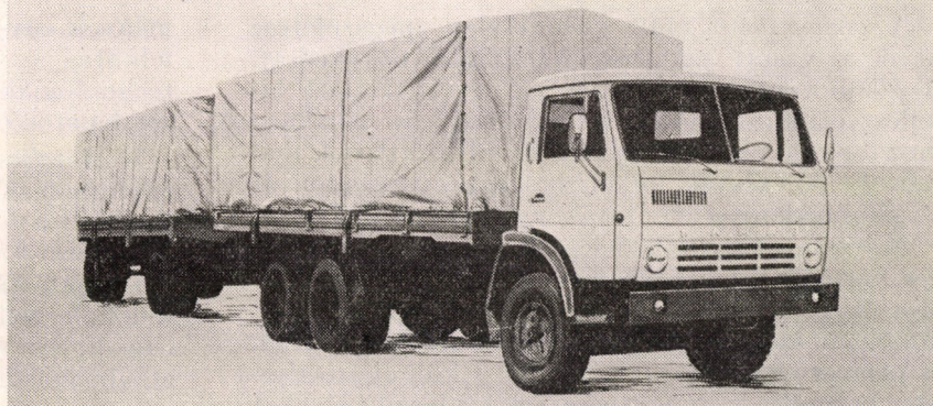
9. ábra. A kámai autógyár összesen 16 tonna teherbírású pótkocsis szerelvénye
