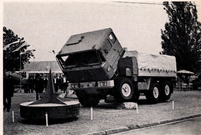
3. ábra. A Csepel-Autógyár D—566 típusú, 5 tonna teherbírású, három-tengelyű nehéz terepjárója, előre billenthető vezetőfülkével
