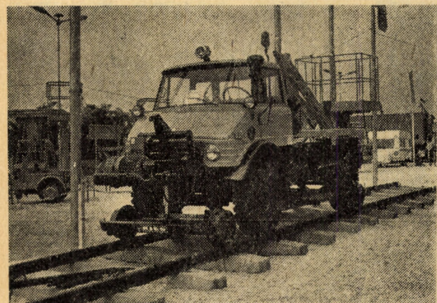
9. ábra. Vasúti pályafenntartási munkák céljára kialakított „kétlű” Mercedes Unimog
