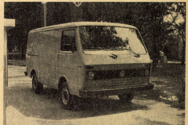
6. ábra. A Volkswagen cég új, LT típusú kisteherkocsi-sorozatának egyik zárt kivitelű, Diesel-motoros változata
