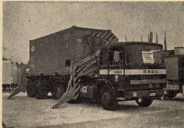
2. ábra. A RÁBA—MAN és Klaus—Kranmobil kooperációban készített önrakodó, konténerszállító járműszerelvény
