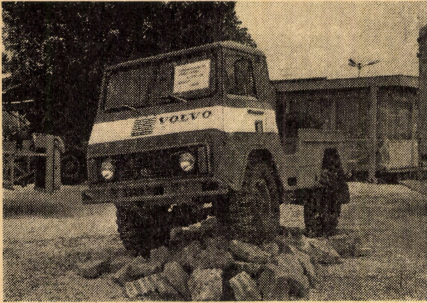
3. ábra. A Csepel Autógyár és a Volvo közös új gyártmánya a C-202 típusú, kisméretű terepjáró gépkocsi
