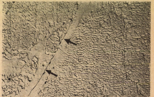
b) Az elektronmikroszkópos felvételen jól kivehető a ferrithálóban terjedő, határozott irányú repedés. N = 1600 , szénreplika
