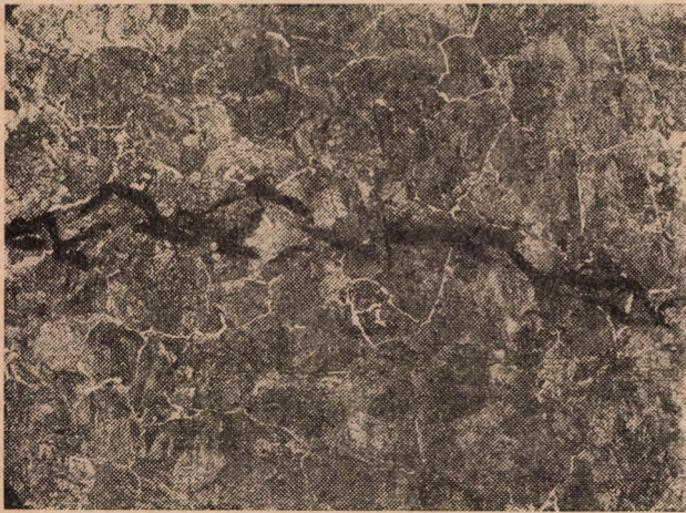
7. ábra. a) A fáradt repedés képe előrehaladottabb állapotban N = 500x, 2% HNO 3
