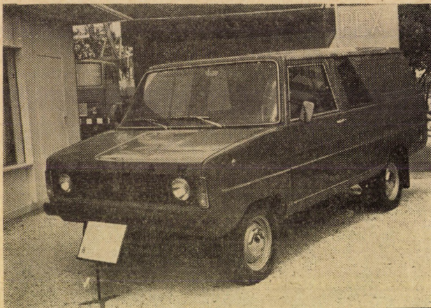
6. ábra. A lengyel autóipar egyik érdekessége: a „Tarpan” típusú, sokcélú, kisméretű haszongépjármű zárt felépítményű változata
